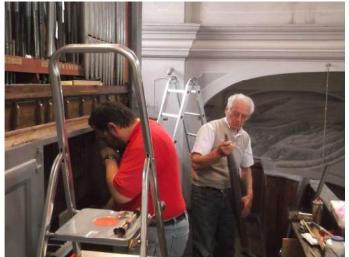
Montaggio e armonizzazione delle canne restaurate
